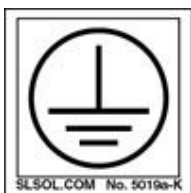
Terra de Proteção IEC 60417-5019
