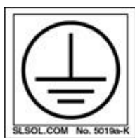
Terra de Proteção IEC 60417-5019
