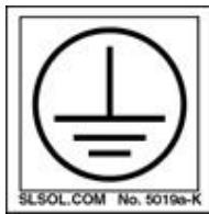
Terra de Proteção IEC 60417-5019
